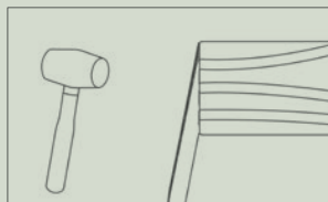
HOEKSTUK – MAAK VOLDOENDE GROTE INKEPING MET EEN SLIJPTOL KORTE STRAAL
